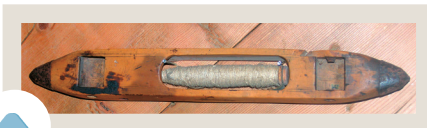
La lanzadera de Kay, inventada en 1733, tejía telas muy anchas con gran rapidez.
